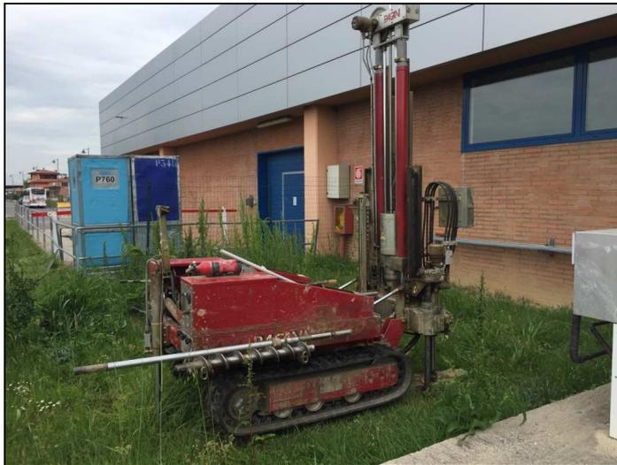
*Prova penetrometrica statica (CPT) n.3.*
