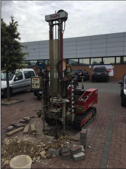
*Prova penetrometrica dinamica (SCPT) n.1.*
