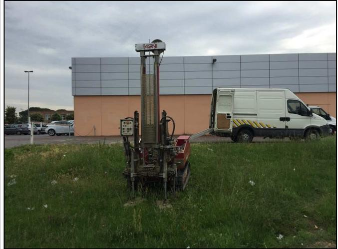
*Prova penetrometrica statica (CPT) n.2.*
