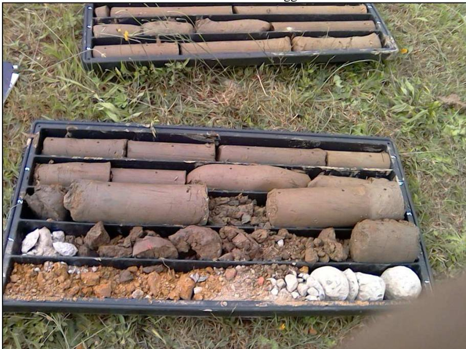
Foto 2: sondaggio S1 da 0 a 5 m
