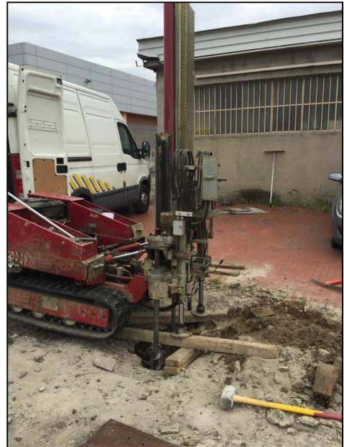
*Prova penetrometrica statica (CPT) n.4.*
