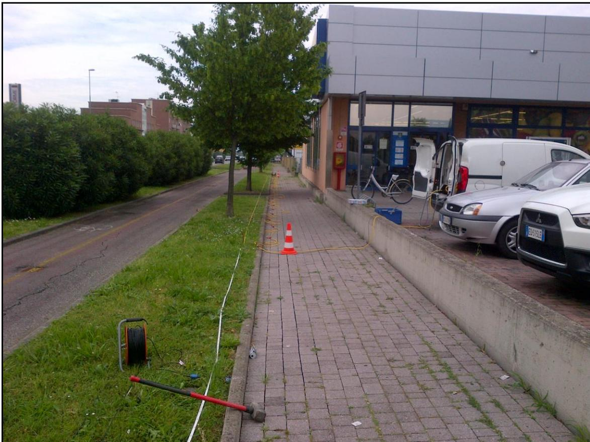
**Figura 3:** Vista dello stendimento MASW effettuato.
