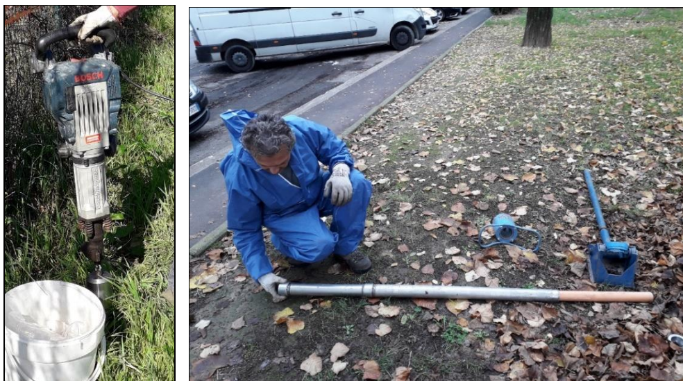
FIGURA 38 - DETTAGLI CAROTIERE MANUALE
