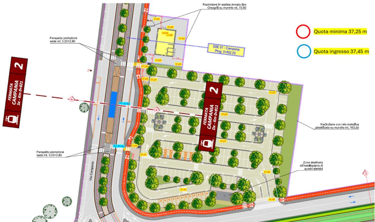
Figura 2 Parcheggio e SSE Elettrica Campania: sistemazione di progetto con evidenza delle quote del parcheggio
