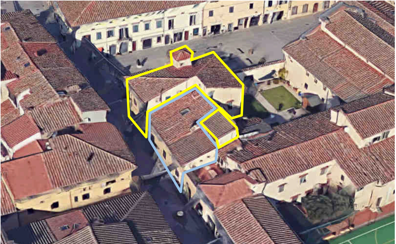
Fig. 1c. Individuazione delle porzioni di fabbricato a tre livelli, in giallo, e delle parti a due livelli, in celeste
