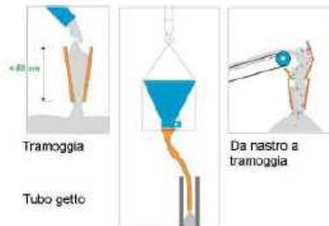
Figura 9: Attrezzature per la messa in opera del calcestruzzo.
