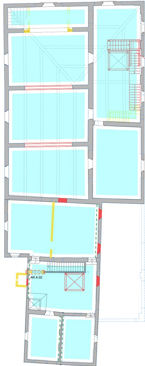
Nuova scala con struttura in acciaio
