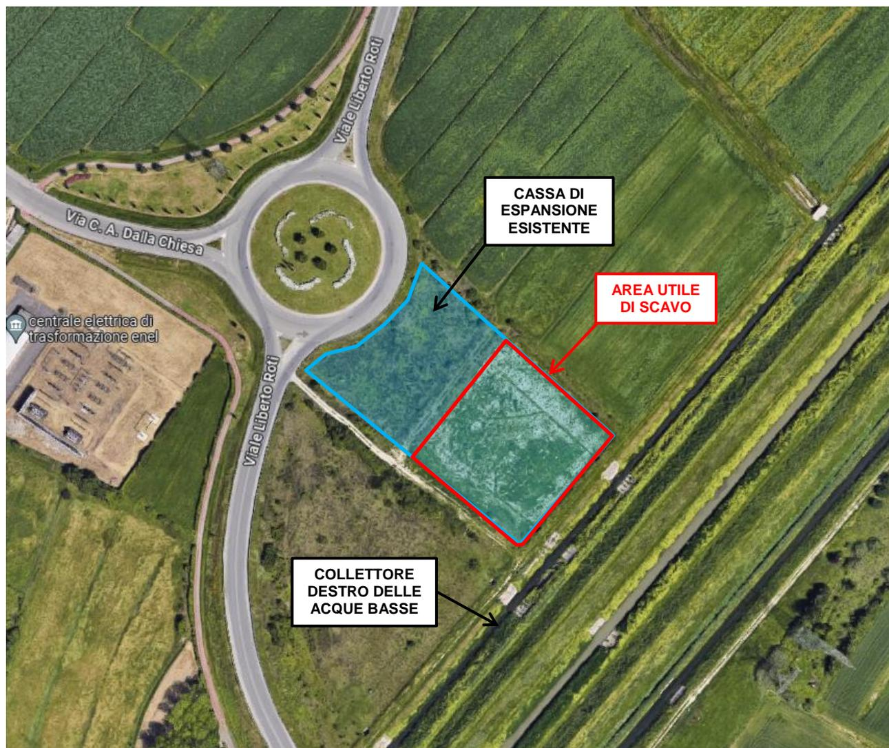
FIGURA 22: CASSA DI ESPANSIONE ESISTENTE SUL COLLETORE DESTRO DELLE ACQUE BASSE
