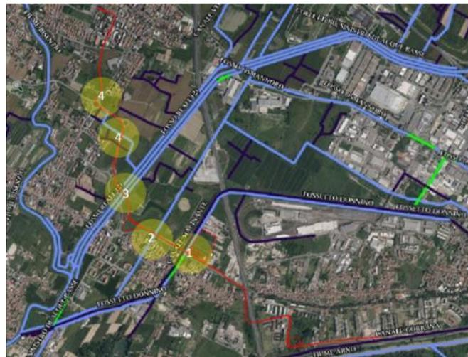
**Figura 6-2 - Interferenze della Linea 4.2 con reticolo idrografico esistente. Evidenziate in giallo le interferenze dirette con il reticolo**
