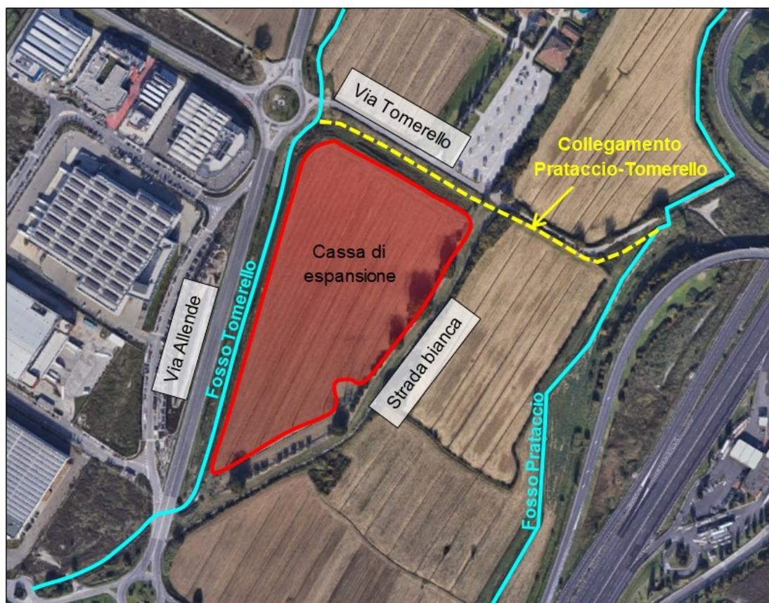
FIGURA 14. AMPLIAMENTO DELLA CASSA DI ESPANSIONE DI PROGETTO IN SINISTRA IDRAULICA DEL FOSSO TOMERELLO
