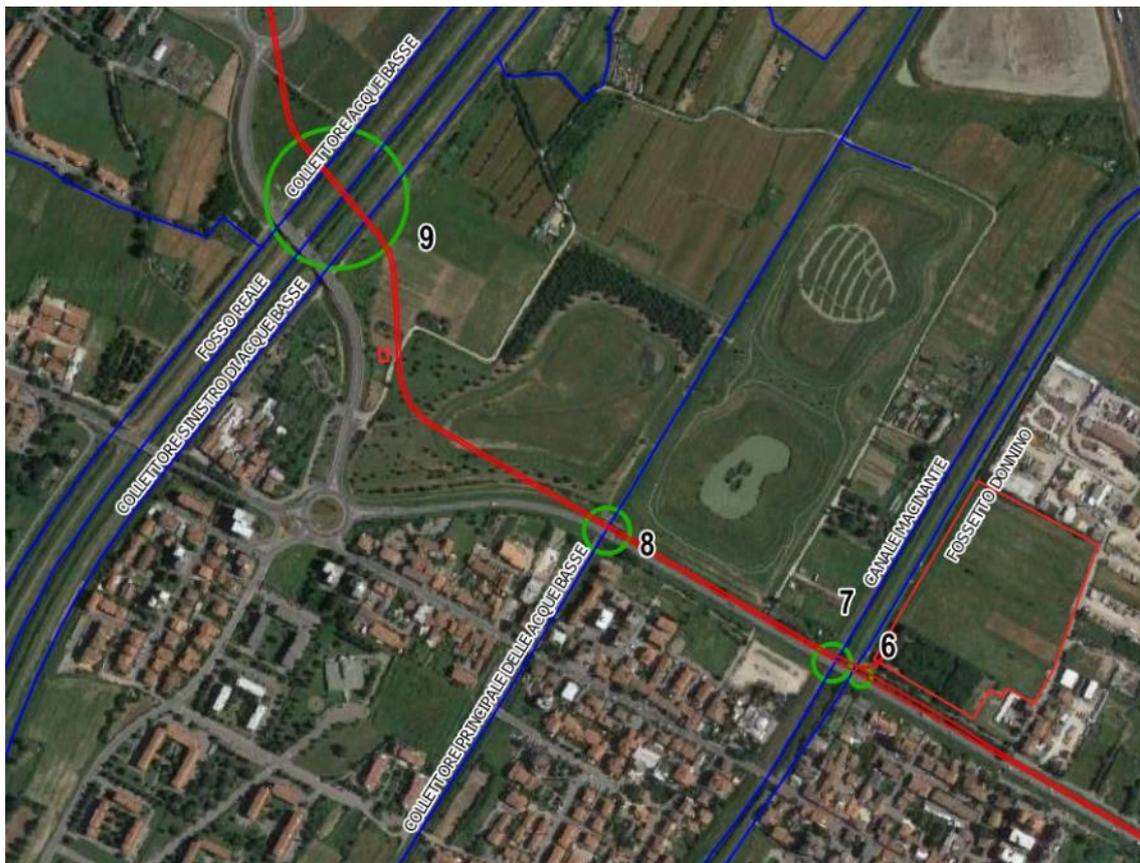
Figura 11: Planimetria delle interferenze con il reticolo idrografico (L.R. 79/2012) - 1 di 2
