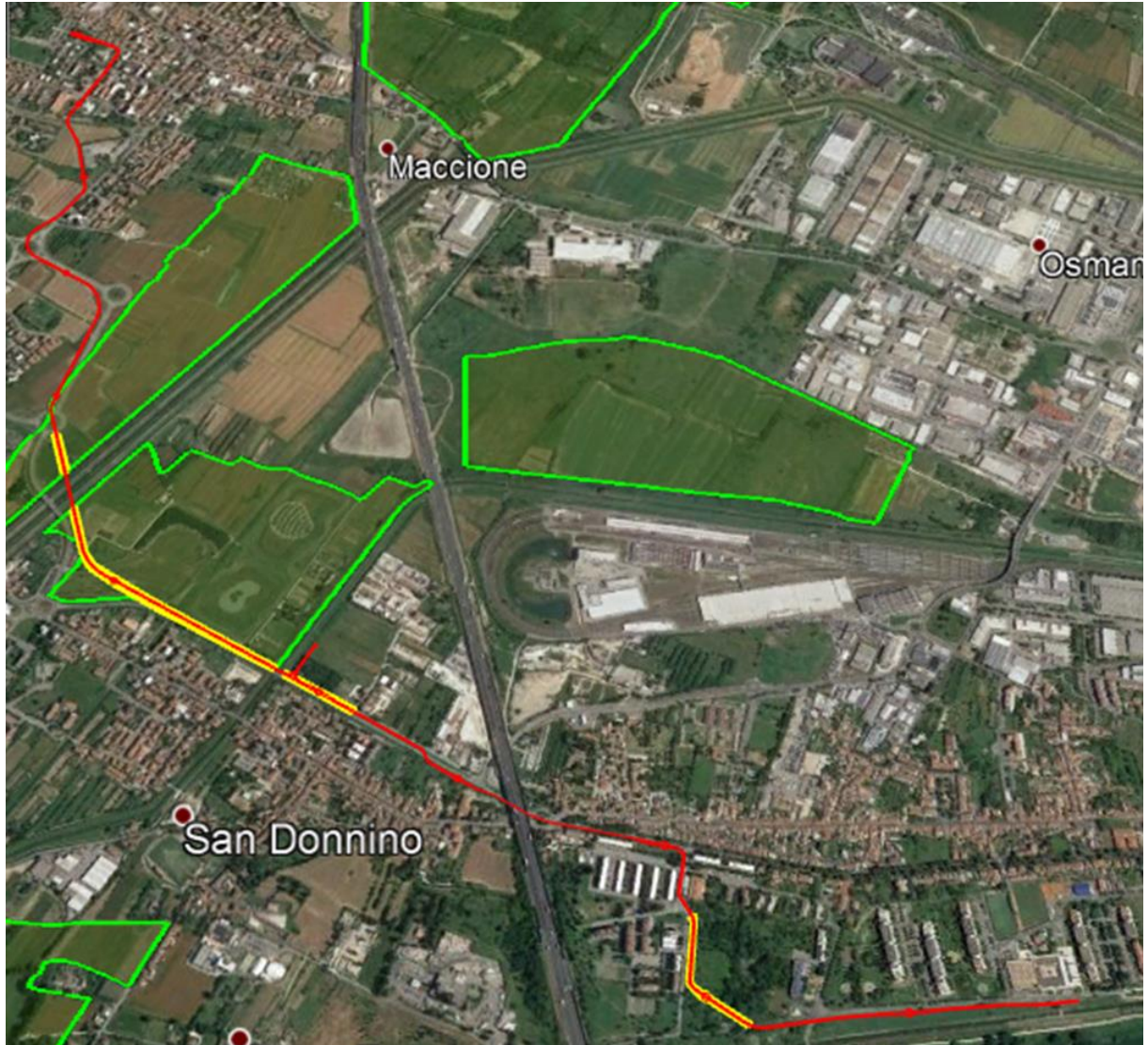
Figura 20: tracciato dell'opera (in rosso) in relazione ai tratti che necessitano di strutture d'impermeabilizzazione (in giallo). In verde il perimetro della ZPS/ZSC "Stagni della Piana Fiorentina e Pratese"
