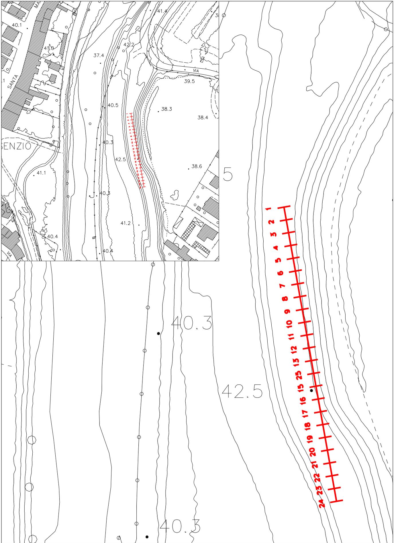
Profilo di sismica a Rifrazione Ps1 - onde SH
