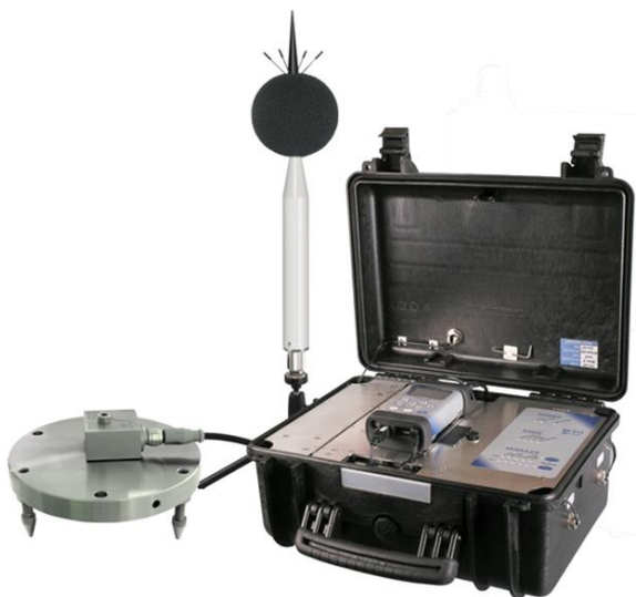
Figura 8 - Esempio di stazione integrata rumore e vibrazioni in remoto con controllo remoto
