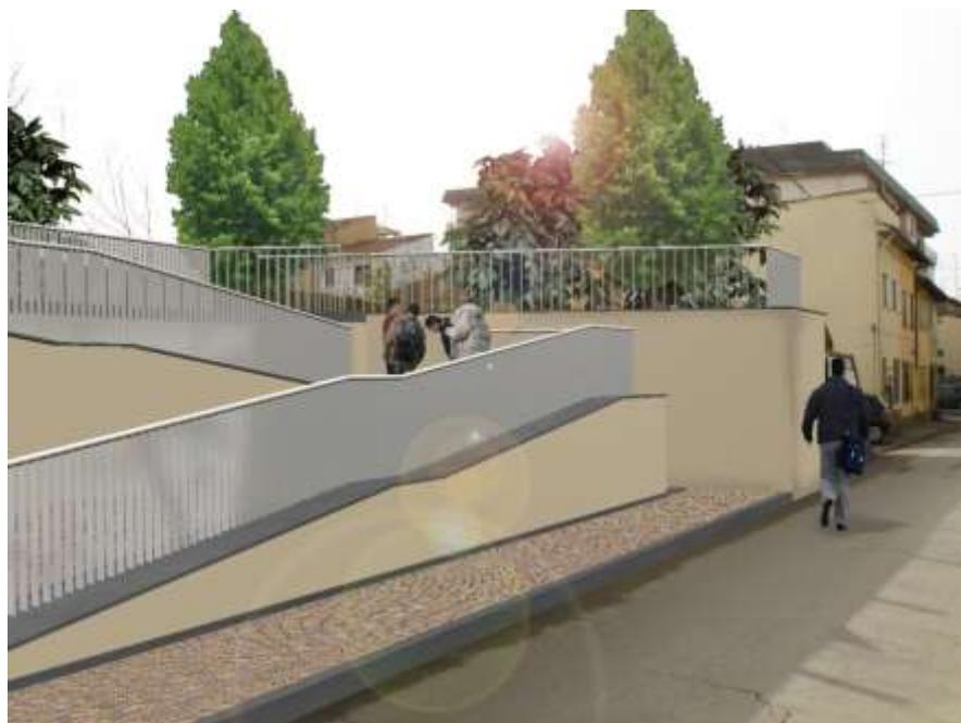
Tale soluzione è ritenuta impattante e si è preferito, d'accordo con il Committente, prevedere il mantenimento del muro esistente praticandovi una breccia di ingresso ed un percorso di approccio all'argine da ricavarsi nel giardino mediante soli movimenti terra (scavi e rinterri) senza opere in c.a..
