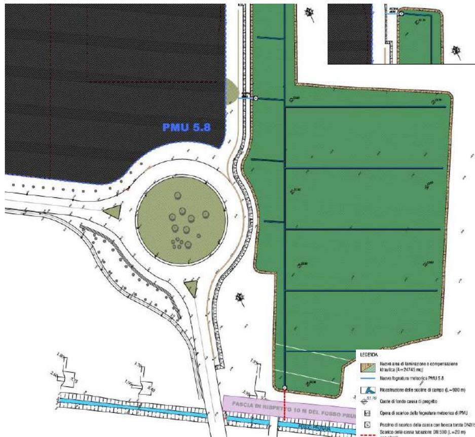
Figura 59 - Tav. G02 Cassa di laminazione e compensazione idraulica (Fonte: G Aspetti idraulici)
