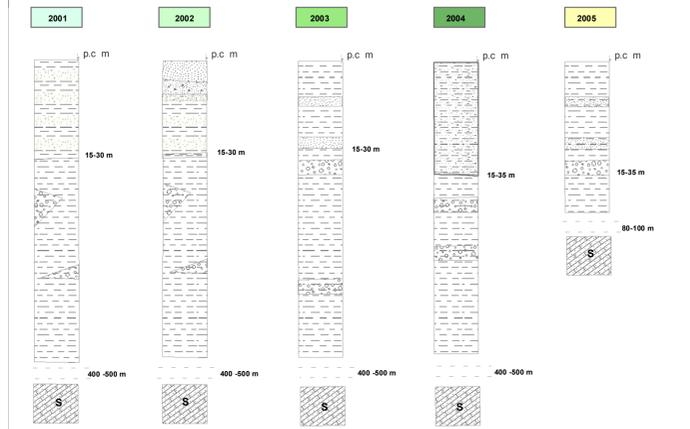
Depositi limosi e/o limosi argillosi con presenza da media a scarsa di lenti e/o orizzonti sabbiosi/ghiaiosi di spessore massimo di circa 5 m
