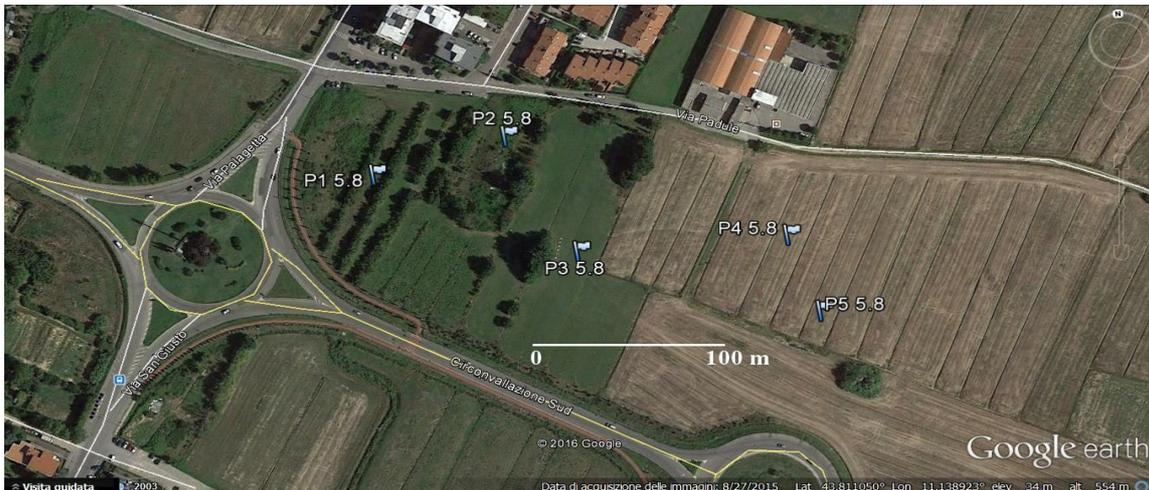
Fig. 8 - Immagine satellitare dell'area d'intervento, con indicati i punti dove sono state effettuate le prove penetrometriche statiche CPT (P1, P2, P3, P4 e P5)
