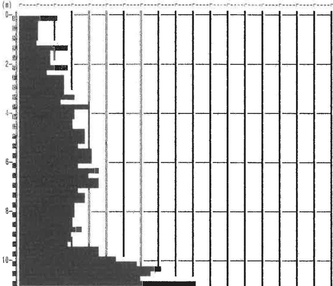
**PROVA PENETROMETR. DINAMICA
