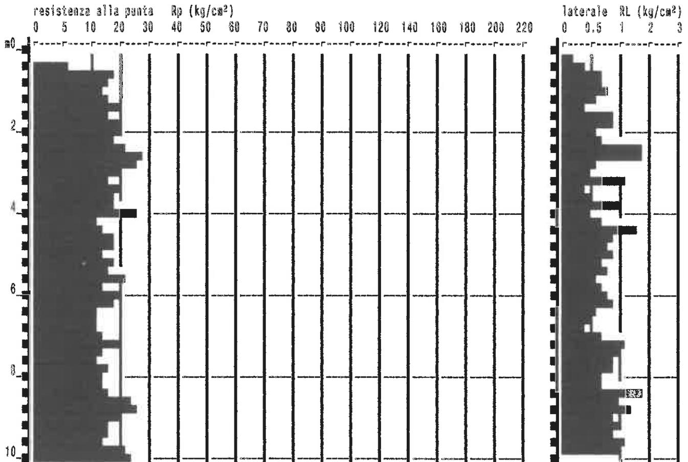
**PROVA PENETROMETR. STATICA
