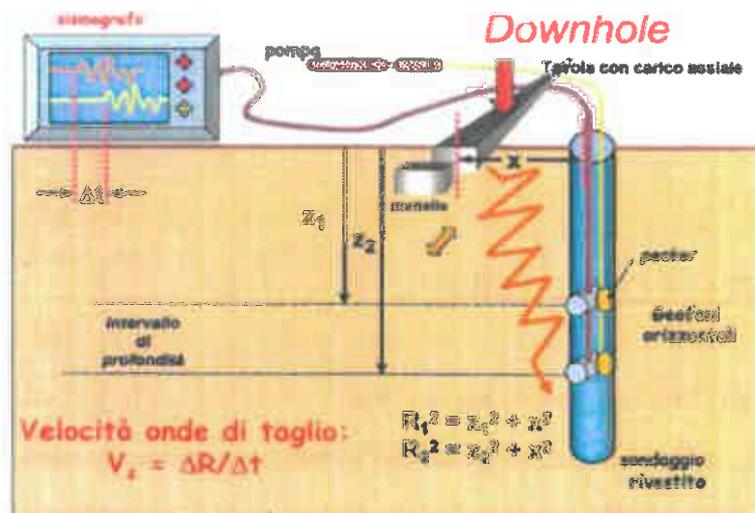
Il tubo di rivestimento può essere costituito da tubazione in PVC o da un tubo inclinometrico.
