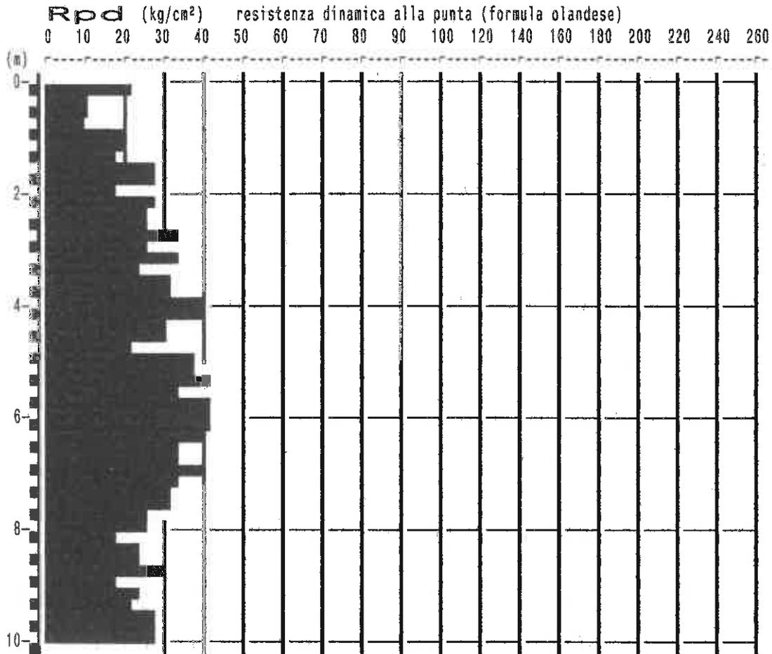
**PROVA PENETROMETR. DINAMICA
