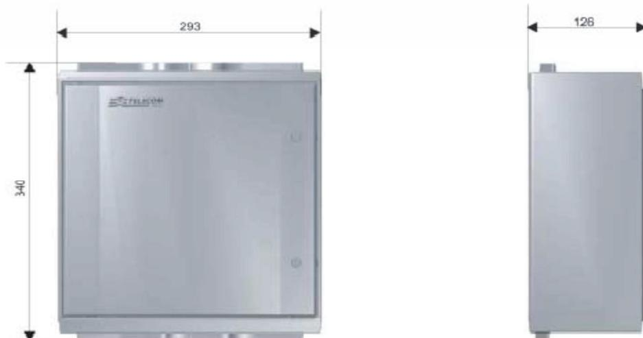
L'armadietto modulare può essere installato ad incasso nei muri o posato a sbalzo. Quando il muro non è di spessore adeguato, l'armadietto può essere incassato parzialmente. In quest'ultimo caso il fissaggio si realizza mediante viti e tasselli ad espansione.
